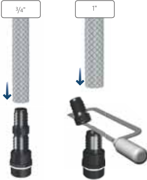
شكل 8 مهائلي المضخات SB و SBA
